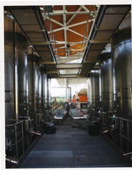
Tintos são fermentados em modernos tanques de aço inoxidável de "dois andares"
